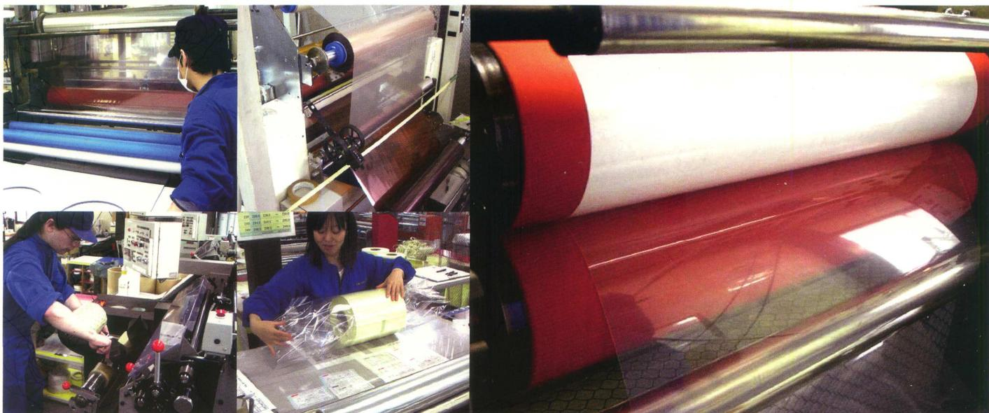
ラミネート加工により、それぞれの素材の持つ長所が結びつき、新しい性能の製品が生まれます。大成ラミネーターのラミネート事業には、各種ラミネーターの他、スリッター、シートカッター、型抜機、焼成炉などを設置し、ラミネートを熟知したスタッフが、より確かな製品をお届けすべく作業に従事しています。特に、最高400℃まで加熱可能な高温ラミネーターや製品巾3500mm対応の大型ラミネーター、真空プレスなどの設備は、他所にはない装置メーカーならではのものです。新素材・新商品開発試作など御検討の際は、是非御相談下さい。
