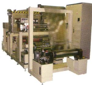
液晶フィルム表面処理積層用ラミネーター
