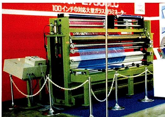
100" 硝子用ラミネーター(自動切断付)
